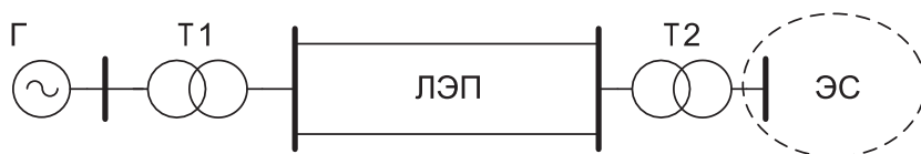
Рис. 1.16 Принципиальная схема электропередачи для рассмотрения вопросов статической устойчивости
